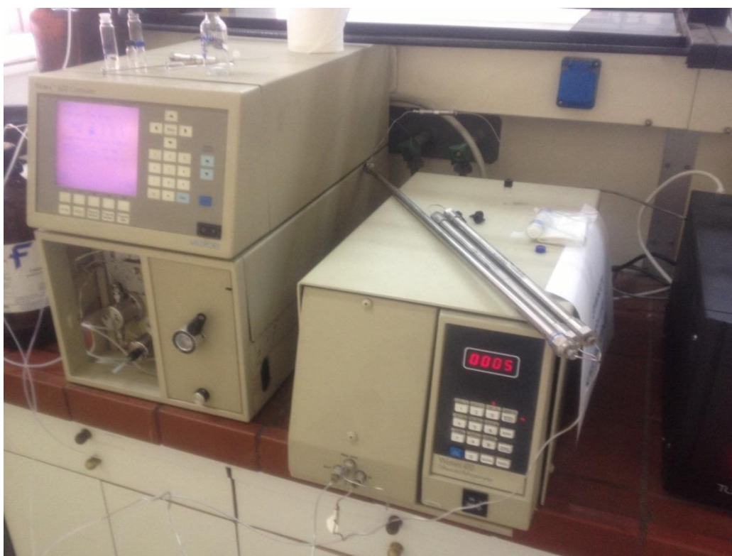
Εικόνα 3.6.: Ο χρωματογράφος της εταιρίας Waters που χρησιμοποιήθηκε στην ανάλυση των δειγμάτων
