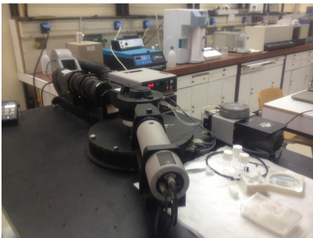
Εικόνα 3.7.: Το φασματοφωτόμετρο της δυναμικής σκέδασης φωτός που χρησιμοποιήθηκε για τον προσδιορισμό του μεγέθους των κυστιδίων
