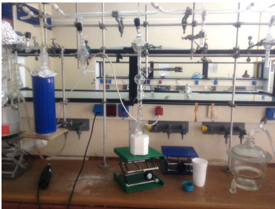
Εικόνα 3.3.: Η πειραματική διάταξη της μεθόδου διαλυτοποίησης - εξάτμισης
