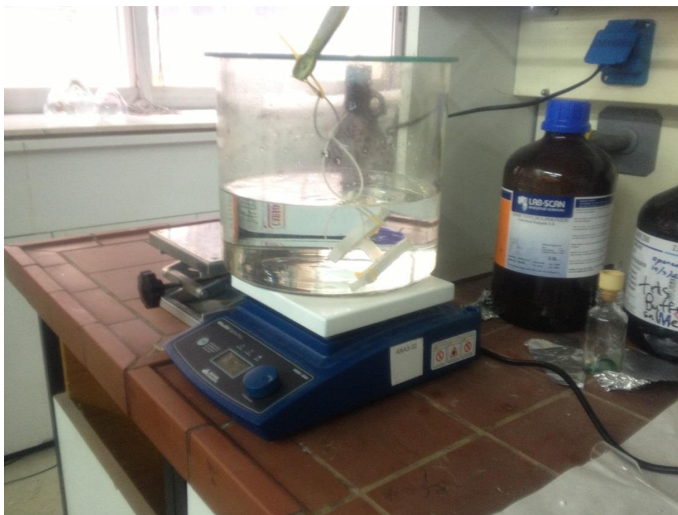
Εικόνα 3.1.: Η πειραματική διάταξη της μεθόδου της διαπίδυσης (dialysis)
